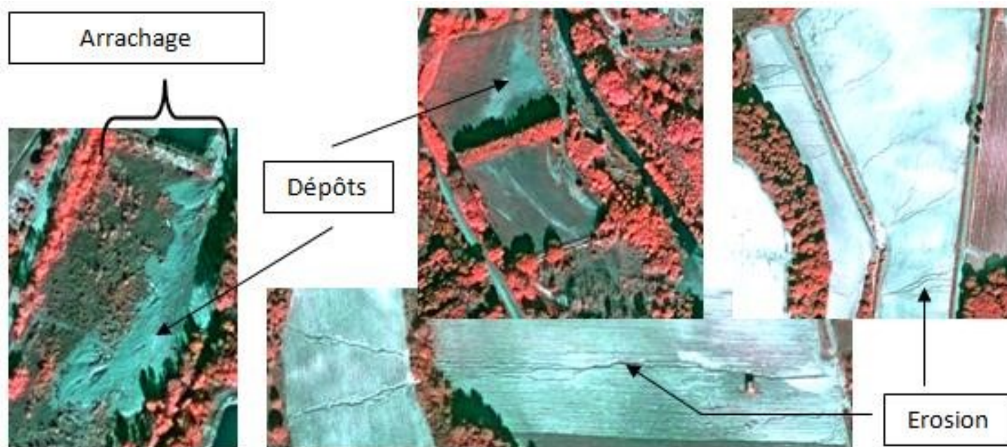
Aléas identifiés par photo-interprétation à partir d'images Pléiades en « fausses couleurs » (Composition colorée R : bande poche infrarouge, G : bande rouge, B : bande verte)
