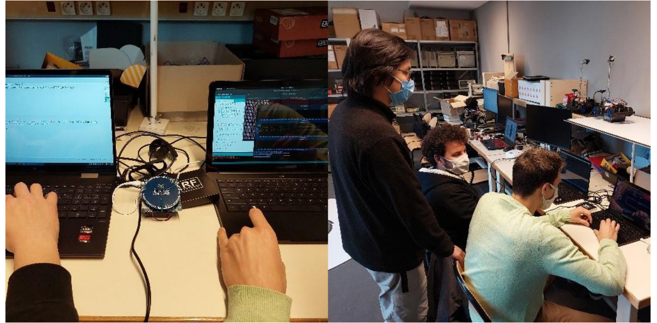
Etudiants du Master EIT-Digital déployant un modèle d'intelligence artificielle pour la reconnaissance d'activité humaine sur les cartes du projet SITH dans le cadre d'un cours sur l'IA embarquée
