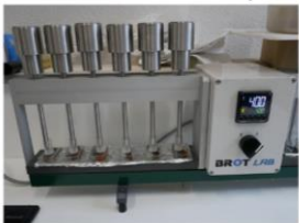
8. Collage des sucres sur les lames de verre dépolies
