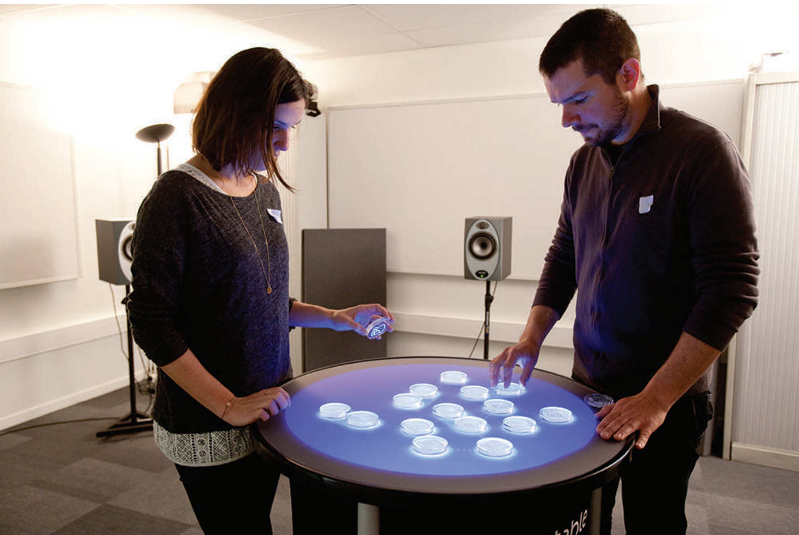
PercepTron, table permettant une tâche de tri libre, utilisée pour étudier la perception des sons © Frédéric MALIGNÉ/MSH Toulouse/CNRS Photothèque
