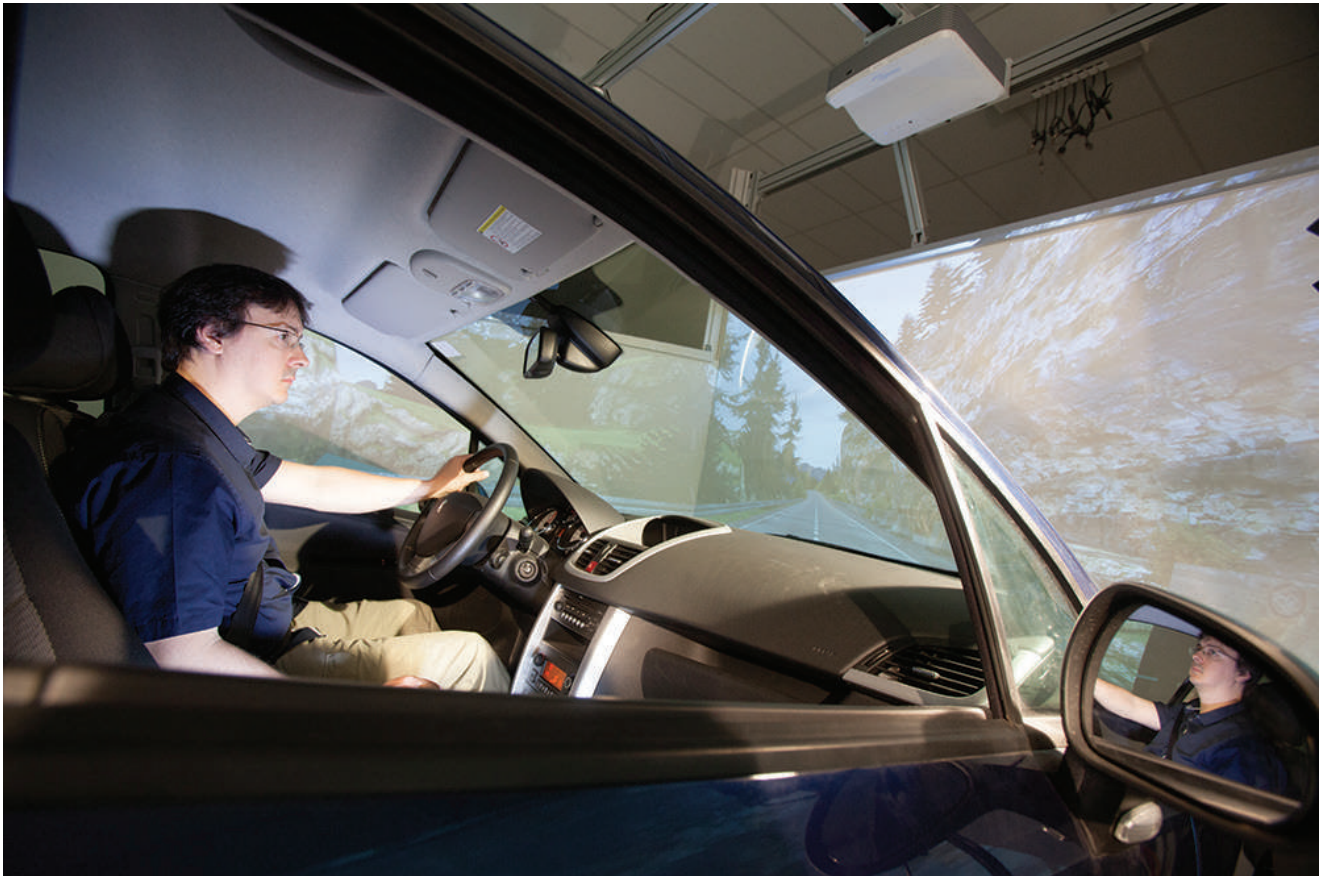
Simulateur de conduite automobile SIMULAUTO pour l'étude sur l'attention du conducteur au volant © Frédéric MALIGNE/MSH Toulouse/CNRS Photothèque
